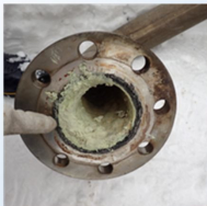
写真 配管内に付着したスケールの例
