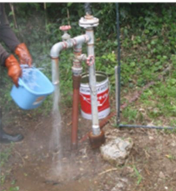
写真 温泉井戸湧出量の手測り観測の様子
