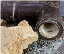
写真 配管内に付着したスケールの例
