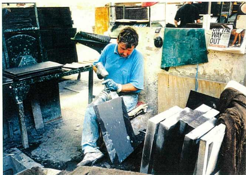
写真 4-5-4 スレート工場 僻開にそって平タガネで割っているところ
