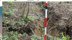
斜面のクラックに降雨が入り崩壊した
