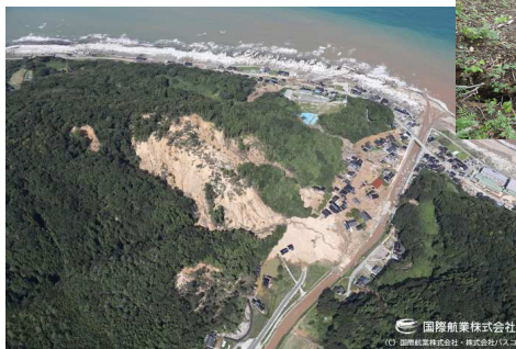
斜面のクラックに降雨が入り崩壊した
