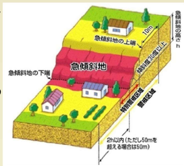
図13-1(左)土砂災害防止法による「かけ崩れ」の対象となる急傾斜地 1)
