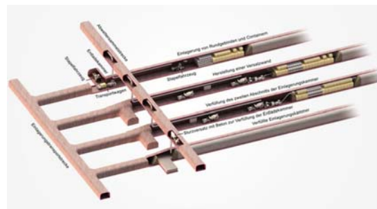
図 5-4-2-11 坑道の処分空洞 19)
