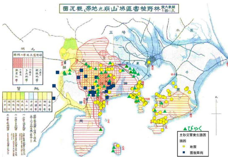
図1 関東地震による林野被害区域「山崩れ地帯」概況図と関東地震による土砂災害地点 井上（2013）に伊豆大島を追記、▲びやくの地点を追記
