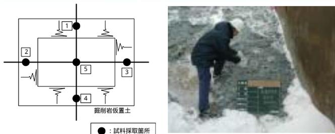
トンネル坑口付近の置き場に搬出された掘削スリについて、約100m<sup>3</sup>毎に5点均等混合法に従い試料を採取した。試料採取は各点100g程度無作為で行なったが、セメント等が付着した部分は意図的に除いた。
