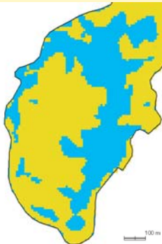
1/25,000地形図から作成 した宅地地盤図 青:切土 黄色:盛土
