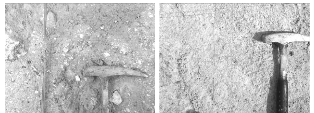
写真-1 火山礫凝灰岩 0t (左：CLL 級，右：CLH 級)
