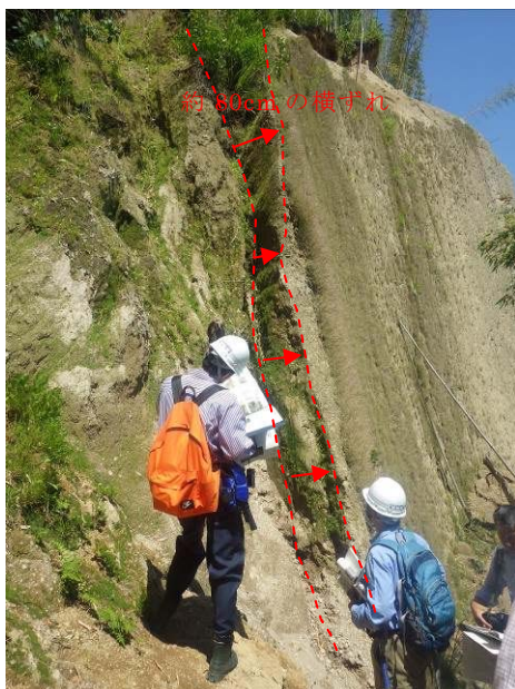
写真-4 益城町上陳の地表地震断層 (約80cmの右横ずれ変位)
