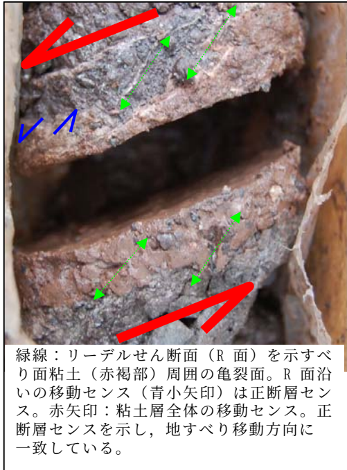
図-3 すべり面粘土の微細剪断構造の事例
