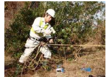
写真 5 軽量動的コーン 貫入試験の様子
