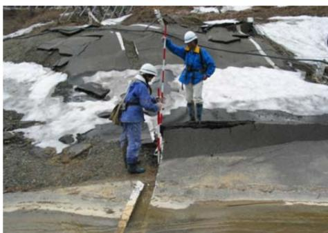
中越地震。地質技術者による被災状況調査。地すべり末端の道路破壊部を調査中。
