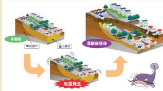
地震による谷埋め盛土すべり
