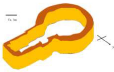
第 11 図 電気探査から推定されたラテライトブロックのイメージ (鳥瞰図)。
