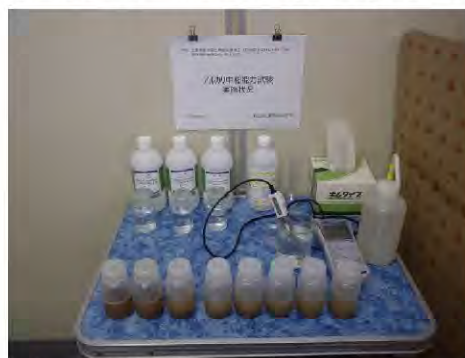
写真-1 アルカリ中和能力試験の状況
