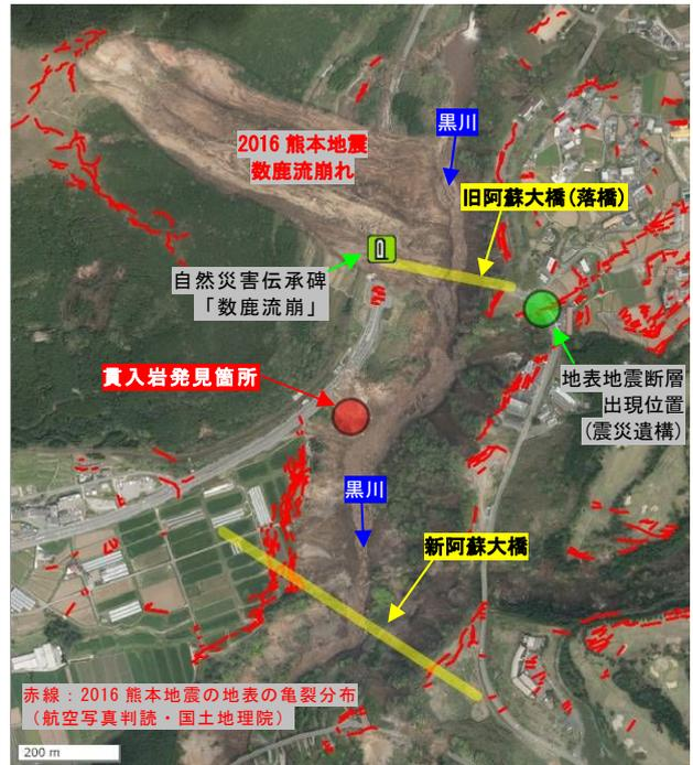
図-3 貫入岩発見位置と熊本地震の斜面崩壊状況<sup>4)</sup>
