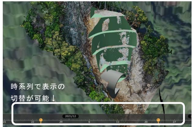
図一3 4次元管理画面での点群と掘削形状
