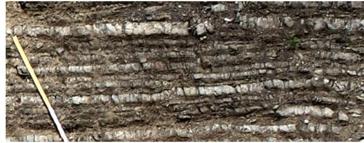
図-3 砂岩泥岩互層の正射投影図(上写真)と層理面間隔(L)と節理面間隔(J)(下図)
