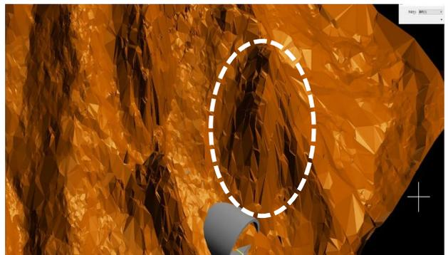
図－1 トンネル近傍斜面の岩盤クリープ状の箇所
