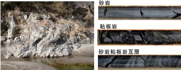
写真-1 調査地に分布する露頭と亀裂の発達した砂岩・粘板岩の代表的なコア写真
