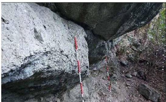
写真-4 自破砕安山岩(br)の露頭状況
