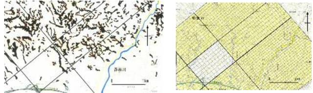
図-2 表層崩壊と土石流による土砂流出箇所図(左)と断裂分布図(右)
