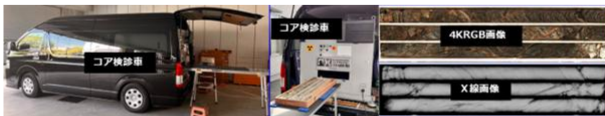
図-1 コア検診車による 4KRGB 画像・X 線画像の取得状況
