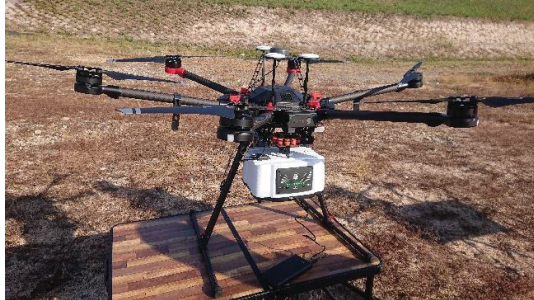
図-1 グリーンレーザドローン測量システム
