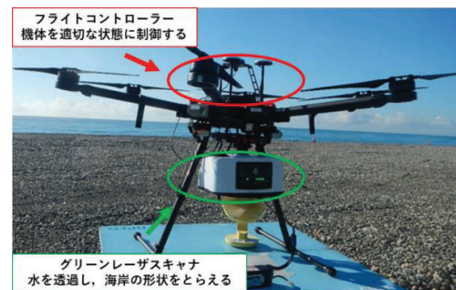
図 2-1 グリーンレーザスキャナの外観
