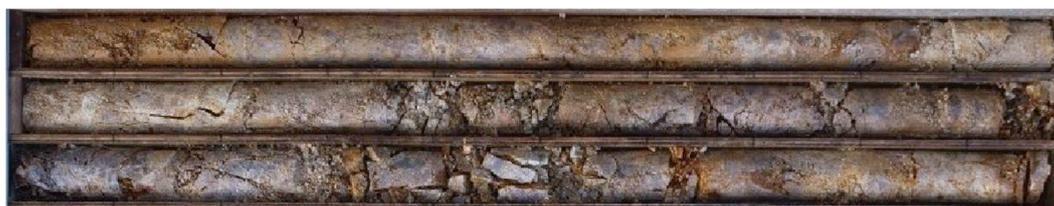
写真-2 ボーリングにより採取された断層破碎帯（横幅 1m）
