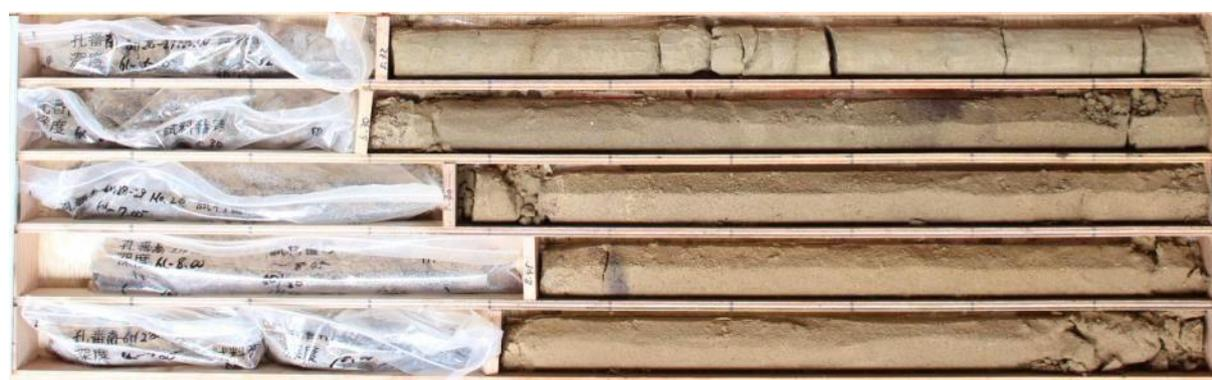
写真-4 堆積軟岩の例(新第三紀・鮮新世の穴内層の砂岩、高知県)
