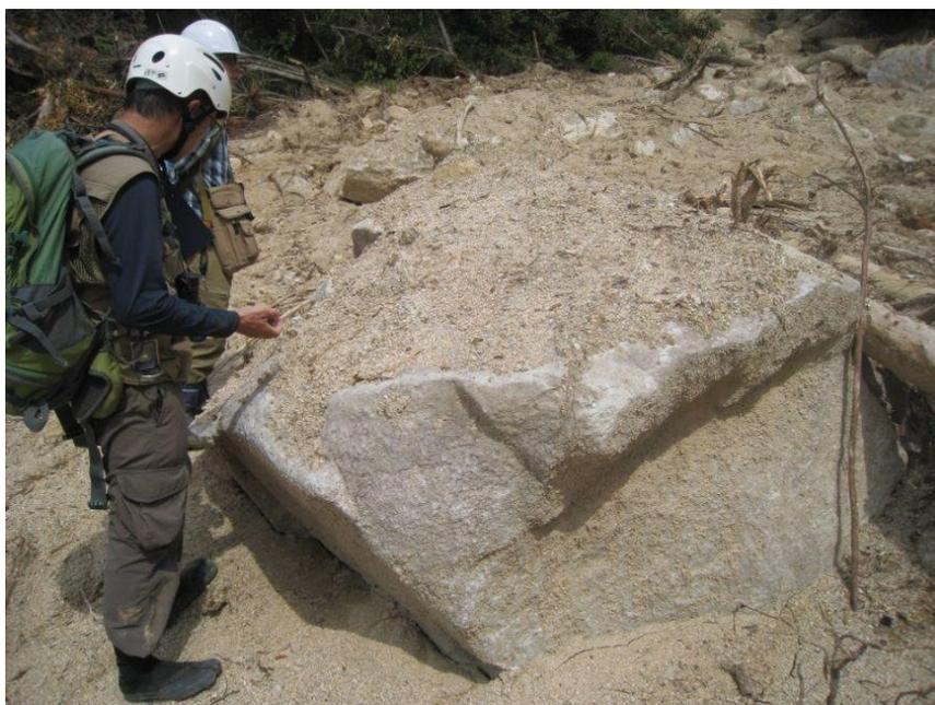
写真-7 土石流溪流内にみられる細粒花崗岩のコアストーン起源の転石
