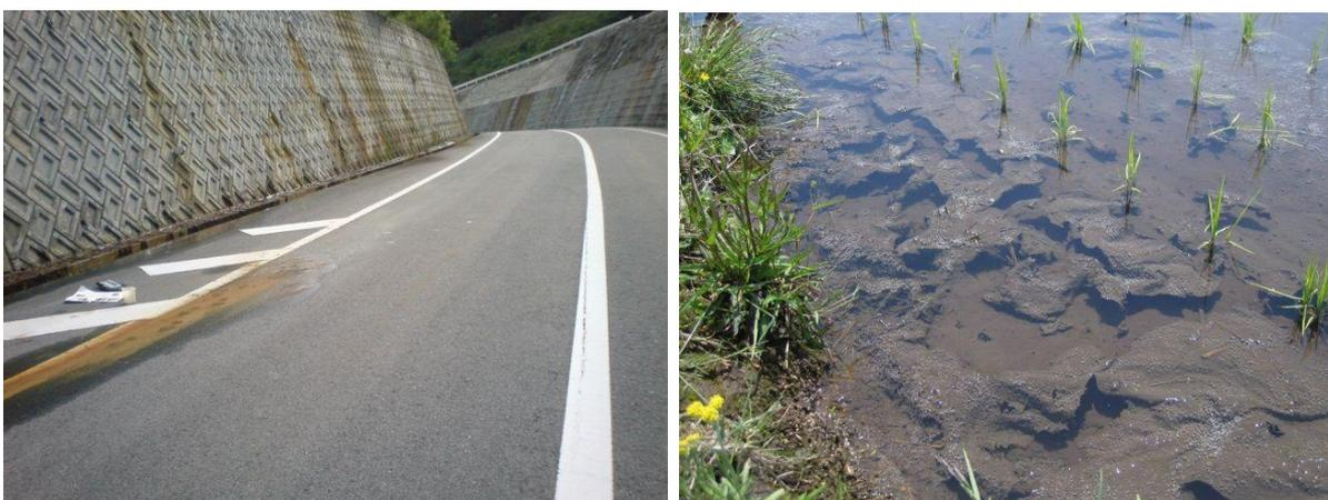
写真-6 酸性水による路盤劣化（左）、水田で増殖した好酸性細菌による表土はく離（右）
