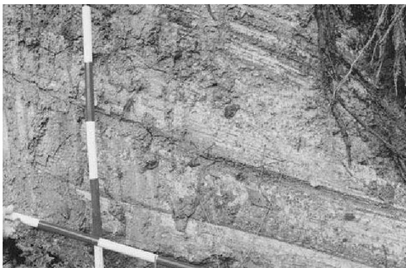
図-2 災害発生時に確認されたすべり面の例<sup>3)</sup>
