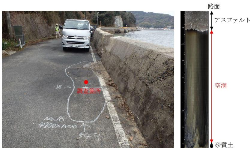
写真-2 地中レーダ探査での異常反射地点とボーリング孔内カメラの映像の例
