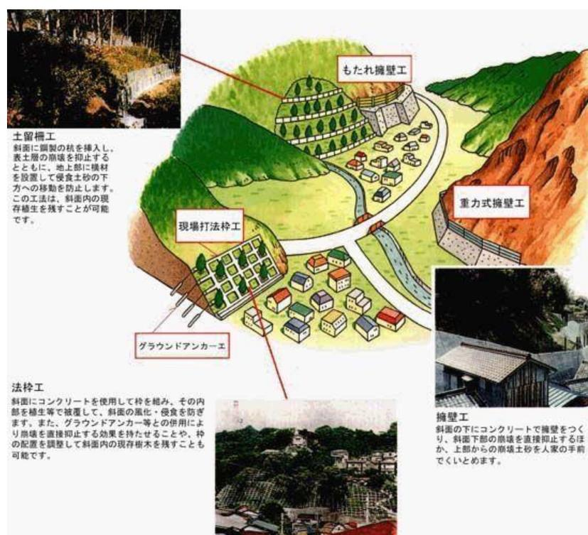
図-3 がけ崩れ対策の模式図<sup>3)</sup>
