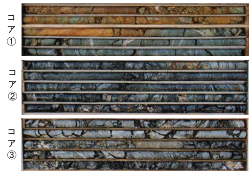
写真-1 地すべりブロック上部(①)中部(②)下部(③)のボーリング試料の一部
