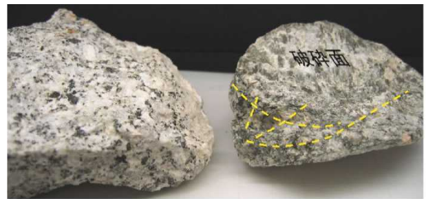
図-5 通常の花崗岩（左）と崩落地のカタクラサイト（右） 2) より引用
