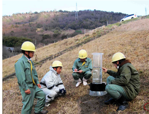
写真-3 堤体のり面部での現場透水試験状況
