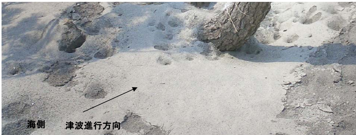
写真-7 海岸部地点B 海岸側からの進行方向にリップルマーク形成
