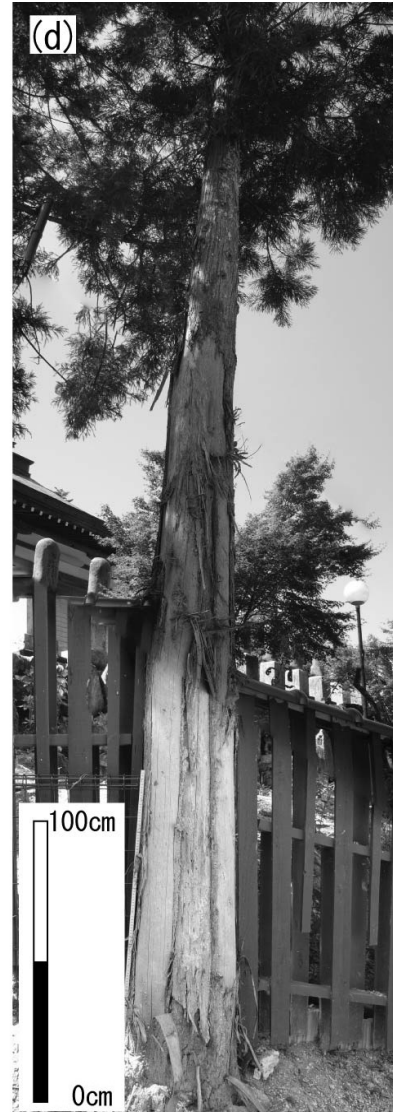
図-3 土石流の洪水位を示す流下痕跡
