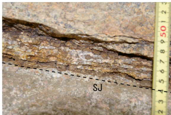
図-11 シーティングジョイント(SJ)に沿って発達するラミネーションシーティング
