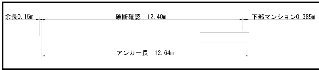
図-7 破断アンカーモード
