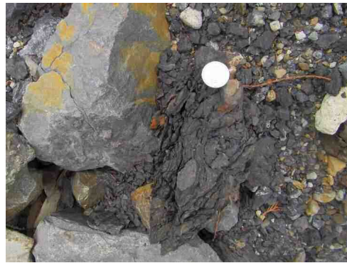
写真1 四万十北帯の泥岩、掘削岩の細片化の事例（硬貨は1円玉）
