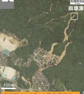
崩壊源はマサ化した風化花崗岩、または表層に堆積した土砂
