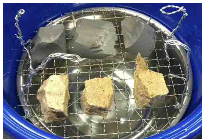
図4. スレーキング試験に用いた泥岩(上)と砂岩(下)
