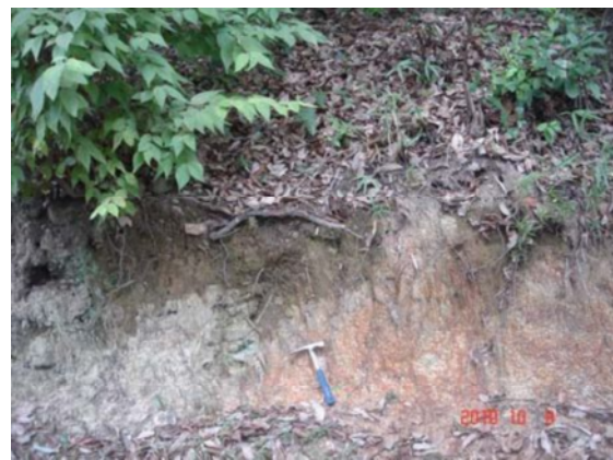
図5 風化した花崗岩を侵食した谷を埋める安山岩由来の崩積土 (礫質粘性土) (三木町白山登山道)
