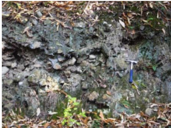
図4 安山岩由来の崩積土 (礫質粘性土) を侵食した谷を埋める安山岩からなる礫層 (丸亀市飯野山登山道)
