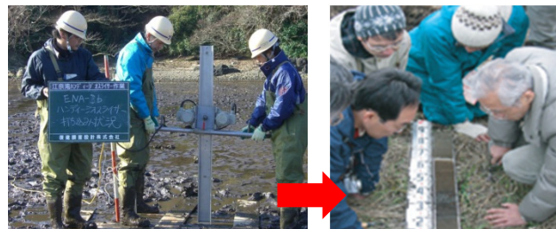
図-4 ジオスライサーの作業模式図(ハンディタイプ、上写真は採取試料の例)
