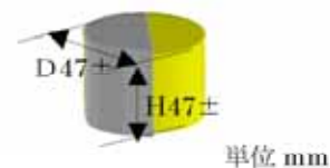
図-1 Protodjakonov 型一面せん断試験 2)
