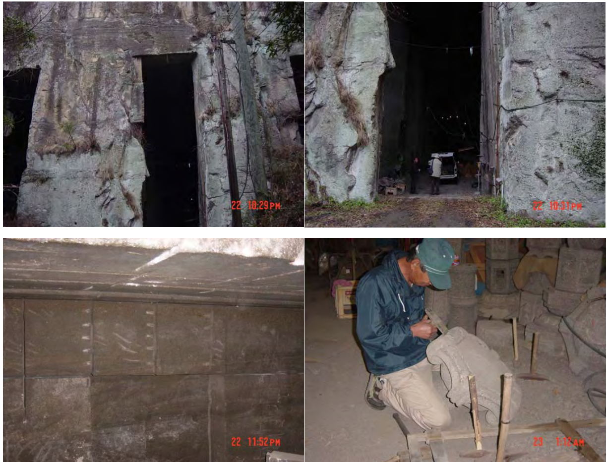
写真 5.4.3 左上，右上：豊島石の坑道掘削の坑口，左下：坑道内の掘削面，右下：豊島石製燈籠の製作状況（写真は香川大学・長谷川修一が2002年に撮影）
