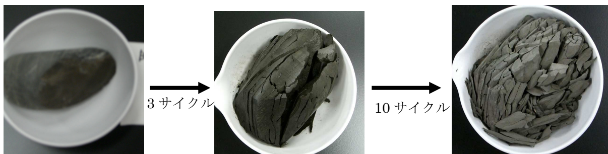
図-3 スレーキング試験時の試料の変化
