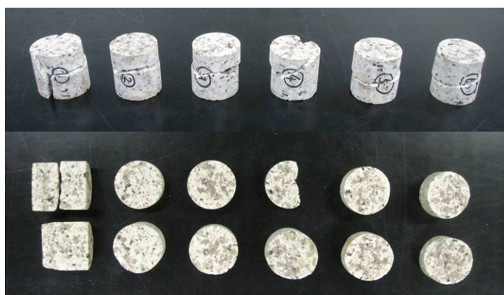
写真-3 試験後の供試体状況 (信楽花崗岩, 上段: 側面, 下段: 破断面)
