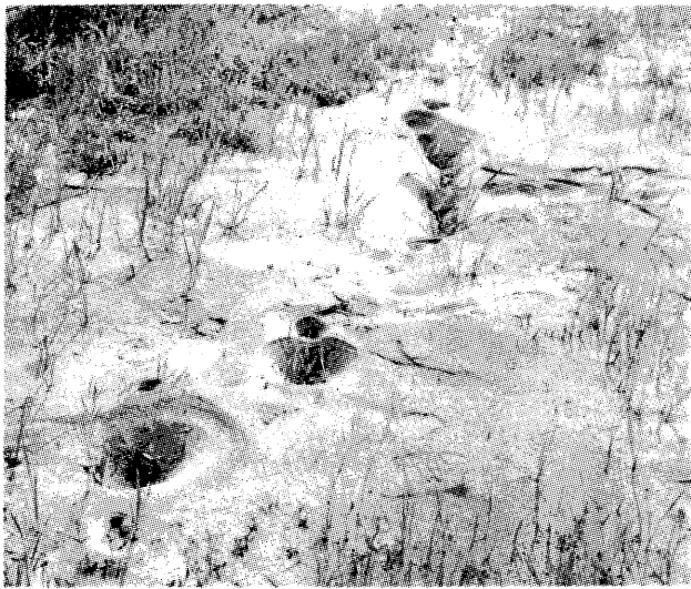
図一1 東予市の埋立地における細砂の液状化
