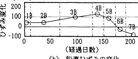
(b) 鉛直ひずみの変化
