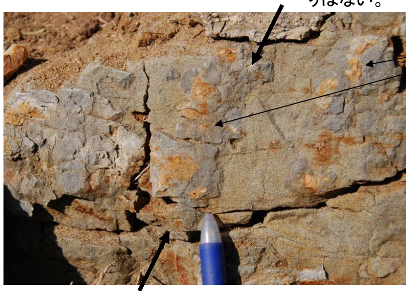
Foot wallに露出する新第三系堆積岩(黄褐色・緩傾斜)。高角度(南西に70~75度)傾斜の断層面に付着するガウジ(灰色)。不明瞭だが、写真の右上から左下に高角度の条線(レイク60~70度)が認められる。出現後、6日経ていること等から、多くの部分は剥落した模様。
