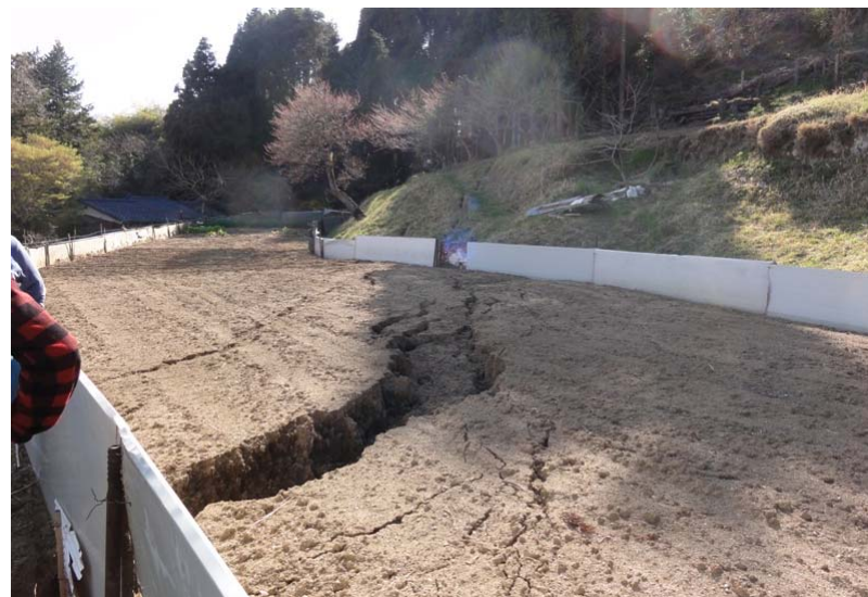
⑥SE方向を望む。土地の方の弁によれば、4月11日の地震で割れ目ができ、12日昼の地震でもっと大きくなった、という。
