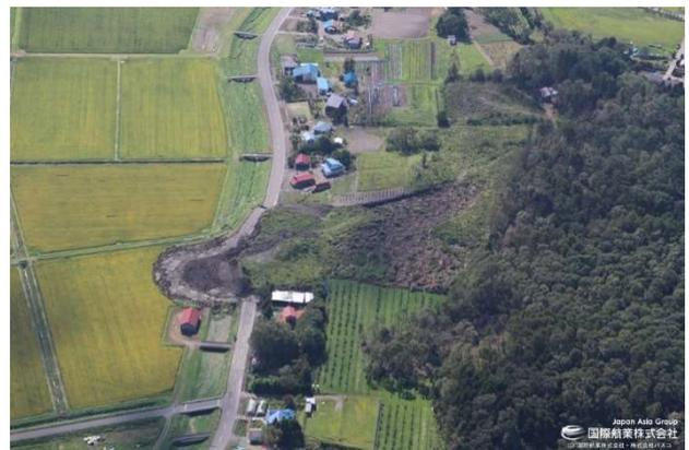
写真-15 写真-13と同地区の斜め写真<sup>7)</sup> (移動体が斜面下の道路を押し出している)
