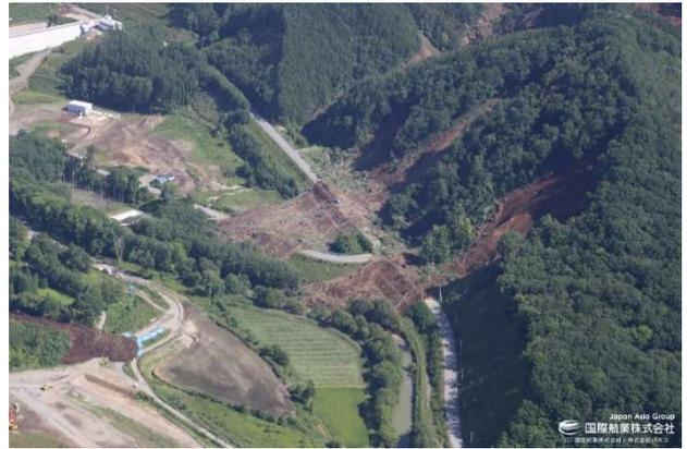
写真-22 急斜面表層崩壊型の事例<sup>7)</sup>(道路盛土を乗り越えて崩壊土砂が流下している.)
