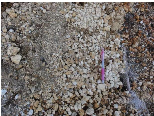
写真-3 崩壊地の滑落面に残存する樽前降下軽石（写真-1, 2と同じ崩壊地）
