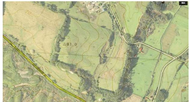
図-3 シート状滑動型の正射影図地形図重ね合わせ図<sup>8)</sup>(地理院地図より作成, 丘陵地の緩斜面(10度前後)で発生している.)
