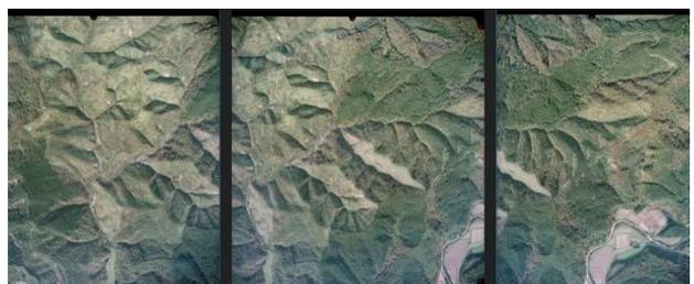
写真-27 発生前の地形（国土地理院撮影1975年<sup>9)</sup>，樹枝状の水系が発達し、V字谷の支溪流が合流する）
