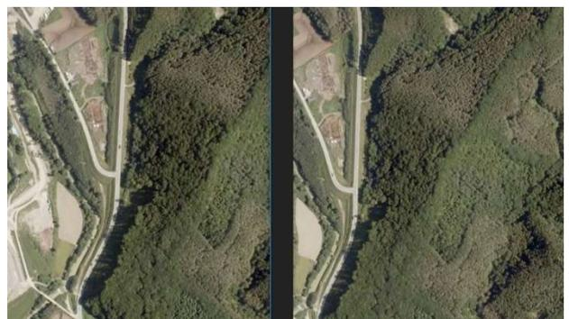
写真-24 写真-22の崩壊前実体写真<sup>9)</sup>(国土地理院撮影2015年, 平滑斜面に不明瞭な谷型斜面)
