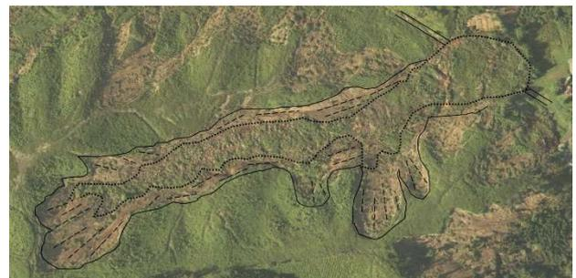
図-6 氷河状谷底堆積物滑動型の形状 (厚真町本郷, 国土地理院正射影図<sup>8)</sup>に加筆)
