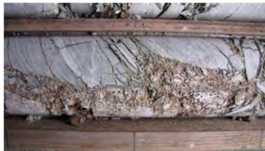
図-5 頁岩が層理面に沿って引き裂かれていく様子。
