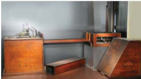
▲ミルンの光学式水平振り地震計〔1894〕 （提供：国立科学博物館/国指定重文）
