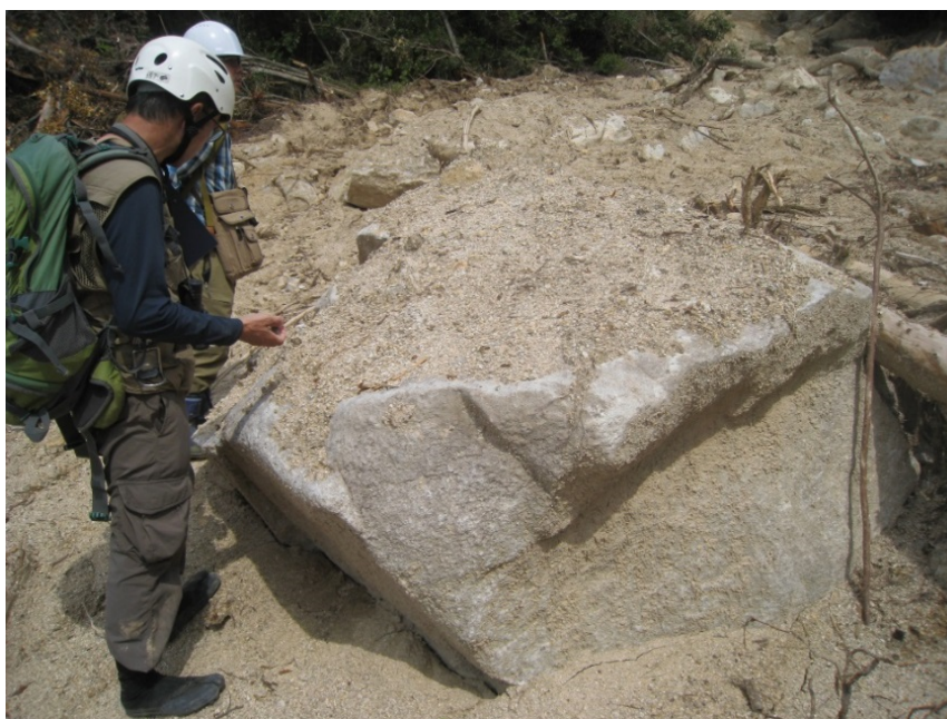
写真-7 土石流溪流内にみられる細粒花崗岩のコアストーン起源の転石 (広島県安芸郡熊野町)
