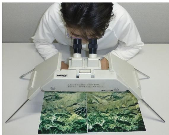
写真-1 実体鏡を用いた空中写真の実体視の様子
