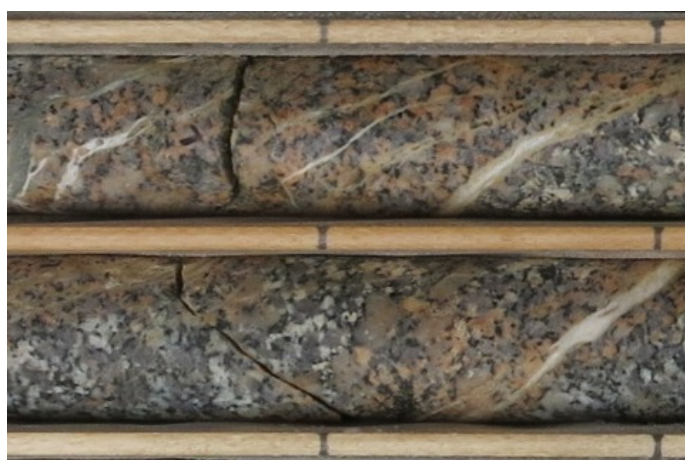
写真-1 花崗岩中に見られる粘土細脈 (ボーリングコア)
