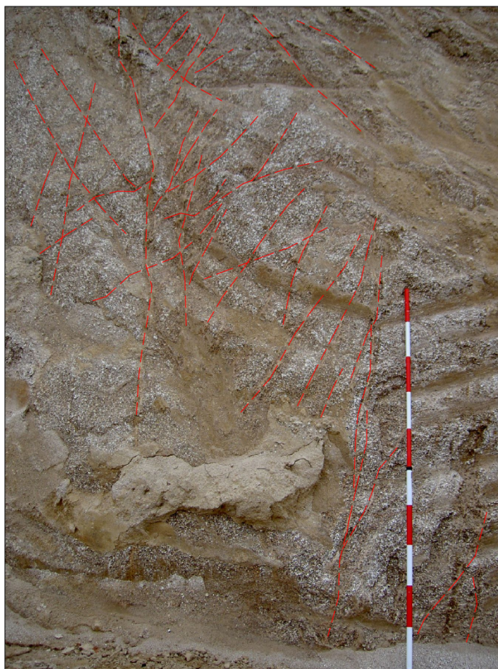
写真-2 花崗岩中に見られる粘土細脈（粘土細脈を赤破線で加筆）
