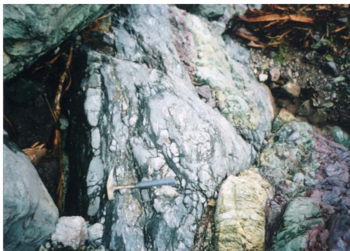
写真-2 メランジュの露頭（徳島県那賀町木沢大用知地区） 基質は泥質岩を主体とし、block-in-matrix 組織を示す 右側の複雑な色調の岩塊は緑色岩である
