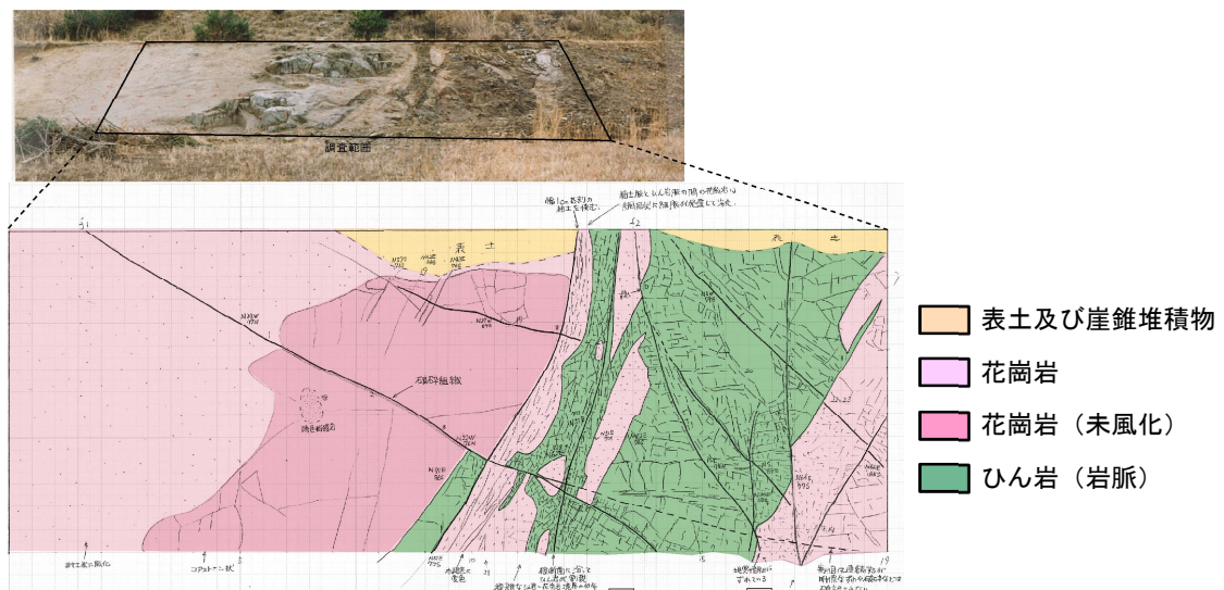
図-1 花崗岩とひん岩岩脈のスケッチ (広島県広島市)
