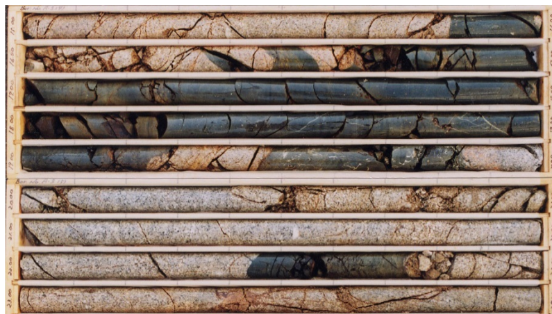
写真-3 ボーリングコアに認められる花崗岩とひん岩の岩脈 (黒色部) (広島県広島市)
