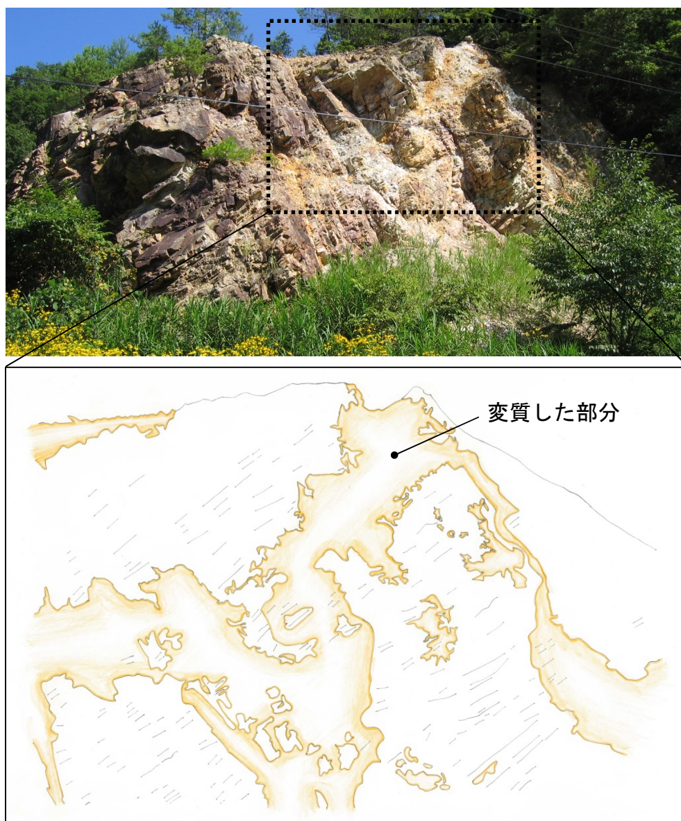
図-3 流紋岩中の熱水変質脈スケッチ（広島県庄原市）
