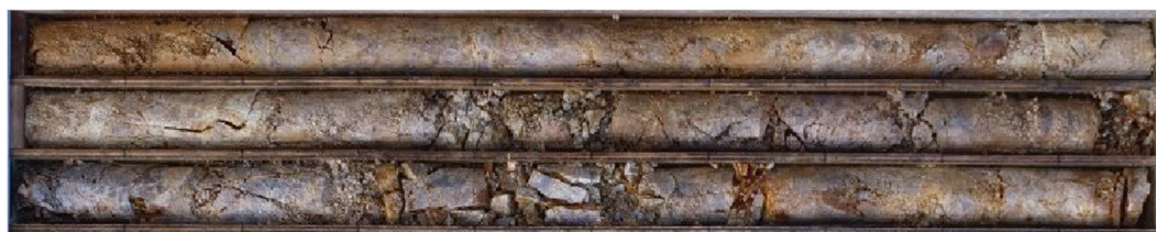
写真-2 ボーリングにより採取された断層破碎帯（横幅 1m）
