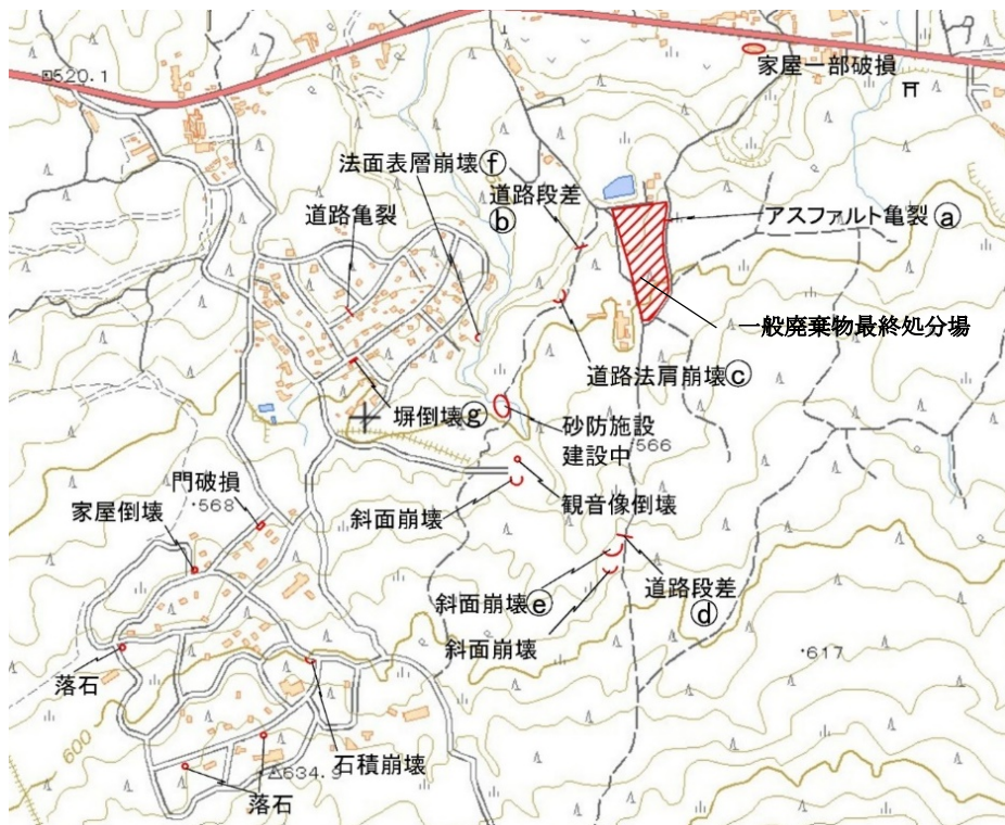
図 2.1 一般廃棄物最終処分場とその周辺の被災状況
