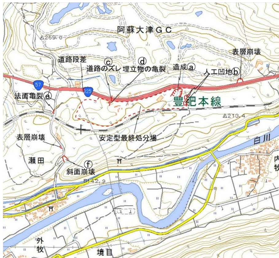
図 2.2 産業廃棄物安定型最終処分場とその周辺の被災状況
