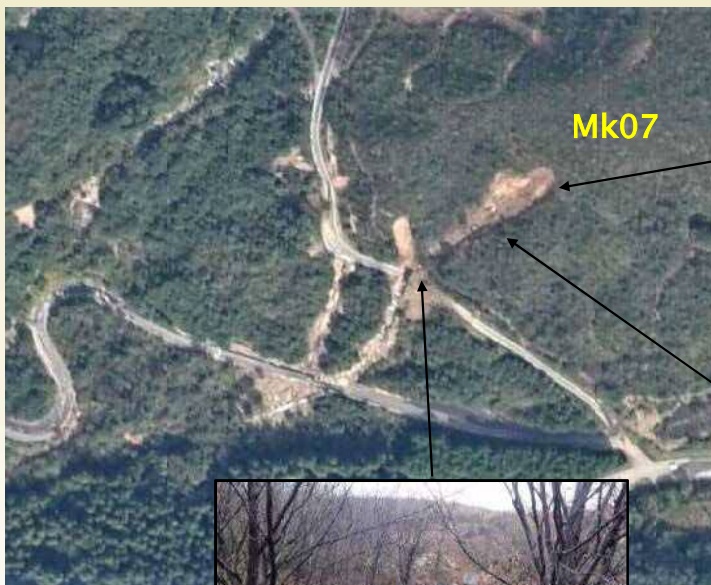
崩壊源頭部(花崗岩と玄武岩の境界付近)
