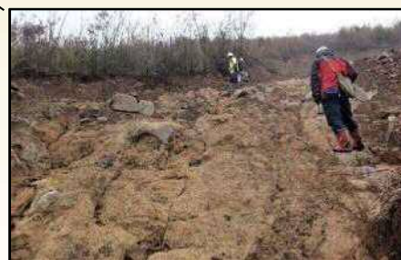
崩壊源頭部(花崗岩と玄武岩の境界付近)
